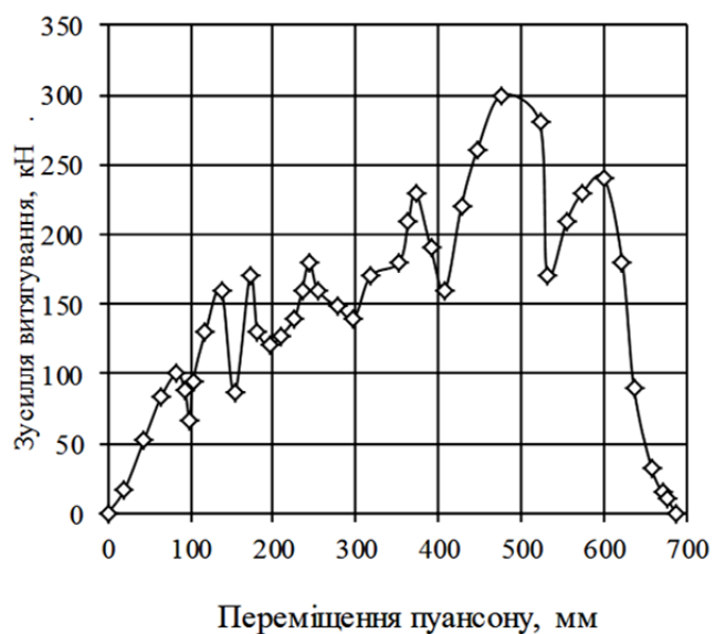
Рис. 3. Залежність зусилля витягування від переміщення пуансону
